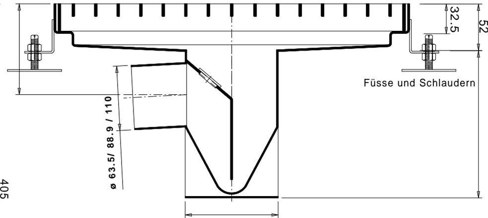
Gitterrost V2A 1.4301 gebeizt und passiviert mit arrondierten Kanten
