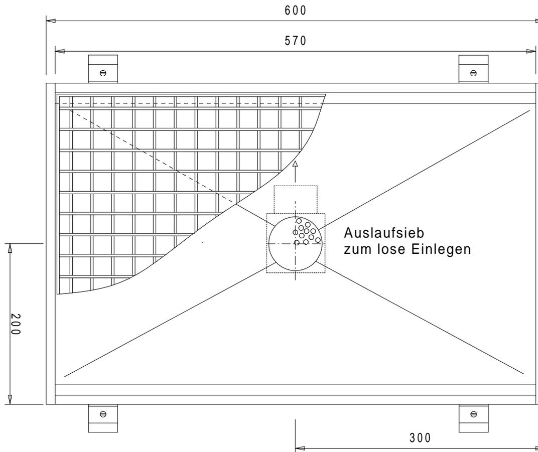
Gitterrost V2A-Stahl, gebeizt und passiviert
