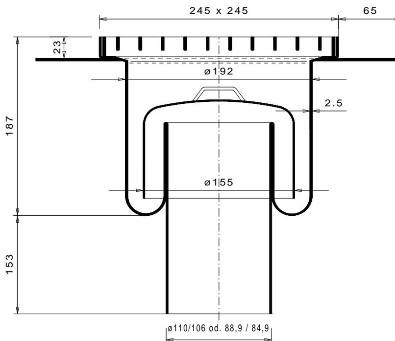
Klebeflansch wird nach Angabe eingeschweisst
